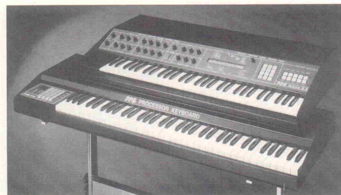
Das Prozessorkeyboard von PPG erzeugt Klavierklänge in allen Lagen sowie die Sounds von E-Piano, Orchester und Schlagzeug und ist dabei anschlagsdynamisch in allen Parametern. MIDI-an Anschlußbereit über das Wave 2.3 (Foto: PPG, Waldorf).
